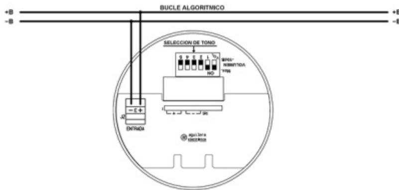
Avant l'installation, il est nécessaire de coder l'adresse que la sirène occupera dans la boucle algorithmique (voir Codage de l'équipement).
